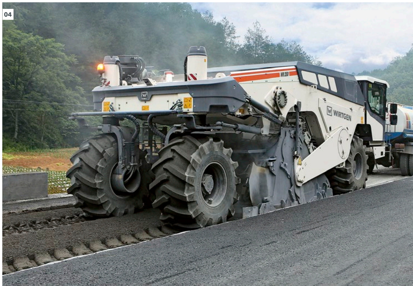
01 - 04 Nel riciclaggio a freddo, gli strati di asfalto ammalorati vengono granulati, miscelati con il legante, trattati, compattati e stesi nuovamente.
