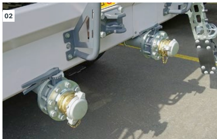
02 Gli attacchi per l'acqua e l'emulsione bituminosa sono ben accessibili.
