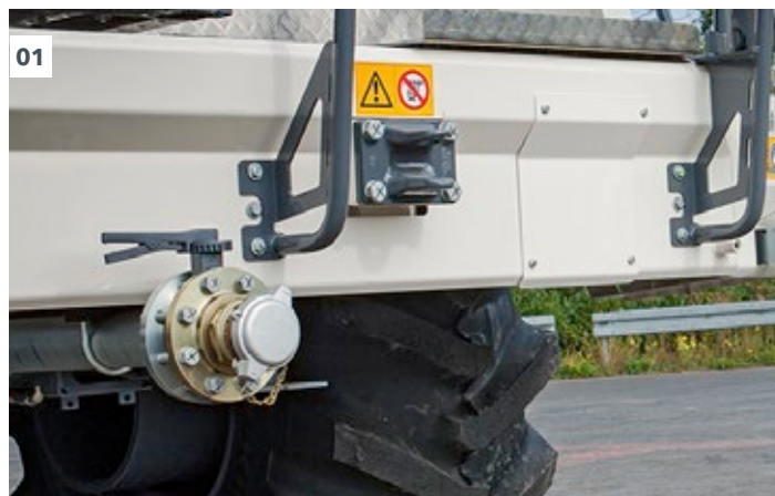
01 Tutti gli attacchi dei tubi flessibili si trovano sulla traversa anteriore.
