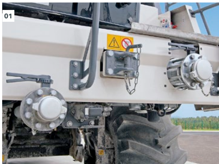
01 Il raccordo per il bitume schiumato è ben accessibile.
