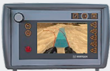
Telecamera di monitoraggio della zona posteriore
