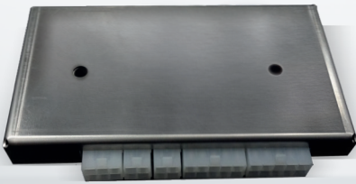
Ana elektrik sistemindeki bilgisayar ünitesi
