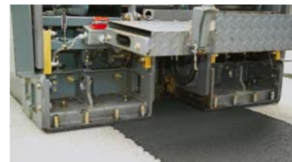
Il sistema di riduzione consente di operare a partire da 0,5 m
