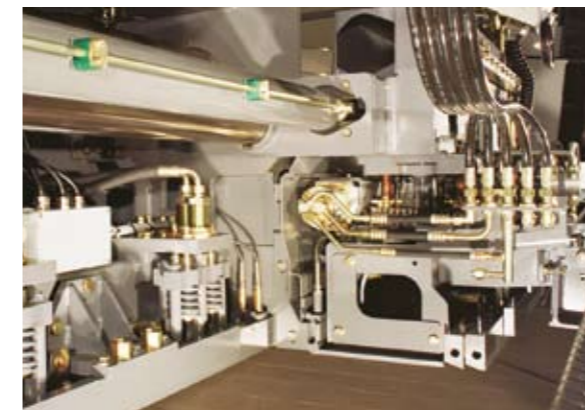
Regla extensible de alta compactación AB 500-2 TP2 con dos listones de presión.
