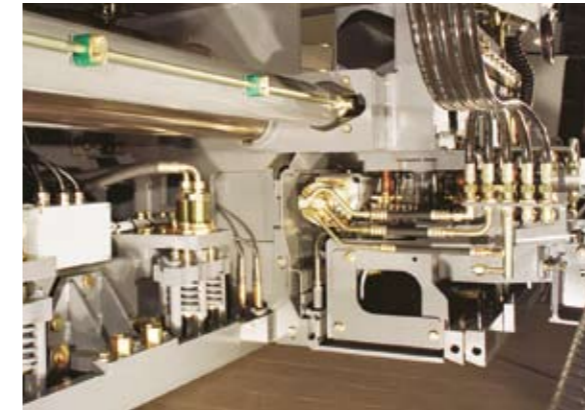
Hochverdichtende Ausziehbohle AB 500-2 TP2 mit zwei Pressleisten.
