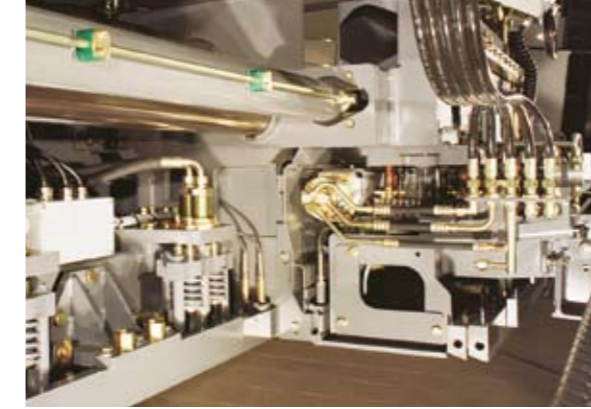
İki adet yüksek sıkıştırma bıçağı donanımlı, hidrolik açılan AB 500-2 TP2 yüksek sıkıştırma tabla modeli.
