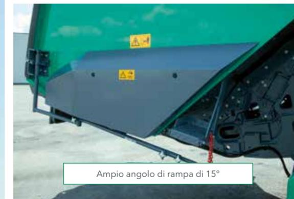
Il trasporto di un alimentatore è un fattore di costo da non sottovalutare. I PowerFeeder VÖGELE della generazione Tratto 3 sono stati studiati da cima a fondo per garantire un trasporto ottimale, aspetto che si riflette positivamente anche sui costi. Il ridotto scartamento esterno dei cingoli di soli 2,66 m e il grande angolo di rampa di 15, ad esempio, permettono di
