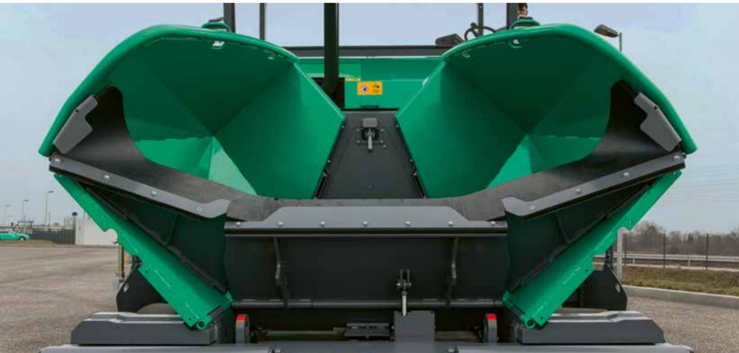
Die Materialquerförderung vor der Bohle bietet beim SUPER 1803-3(i) alle Möglichkeiten, um in jeder Einbausituation eine optimale Mischgutvorlage zu erzielen.
