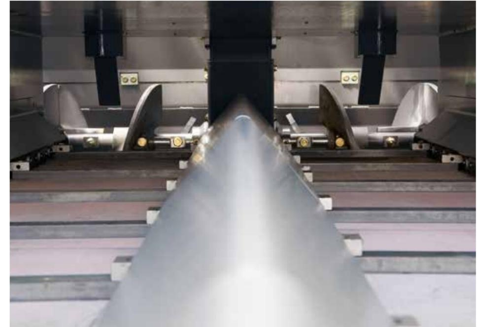
Das Kratzerband kann mit nur einem Tastendruck reversiert werden. Der Rücktransport des Mischgutes stoppt automatisch. Ebenso schnell kann das Kratzerband in die Leerlauffunktion gebracht werden.
