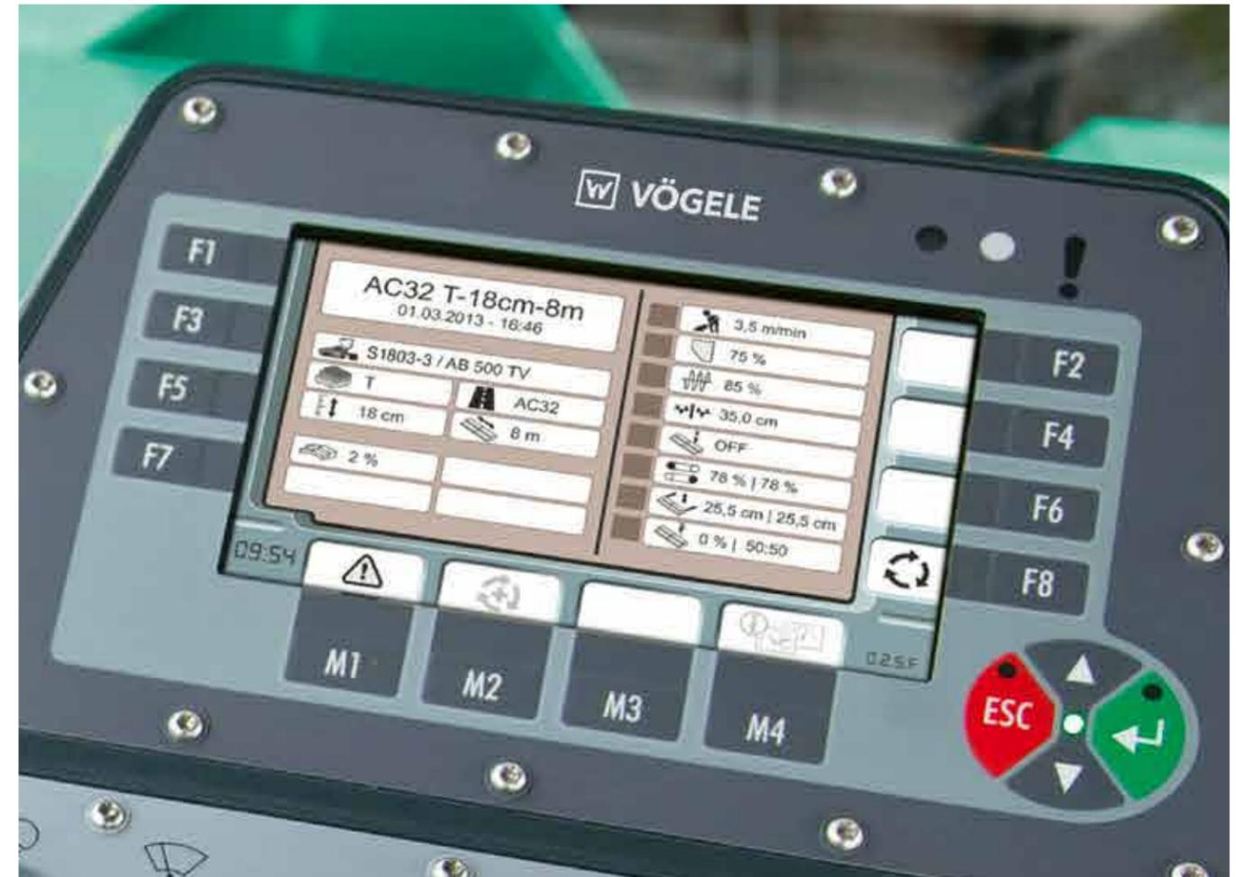
Die Automatikfunktion für Einbauprogramme ermöglicht es dem Bediener, bestimmte Einbauprogramme anzulegen. So können alle wichtigen Parameter für den Einbau einer bestimmten Schicht, z. B. einer Tragschicht aus Asphaltbeton in 18 cm Stärke, abgespeichert werden.
