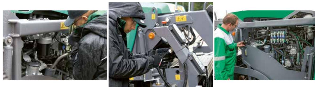
Le concept de service unique des finisseurs VÖGELE permet d'effectuer un entretien rapide. Tous les points de service de la machine sont aisément accessibles par les grands abattants de service.
