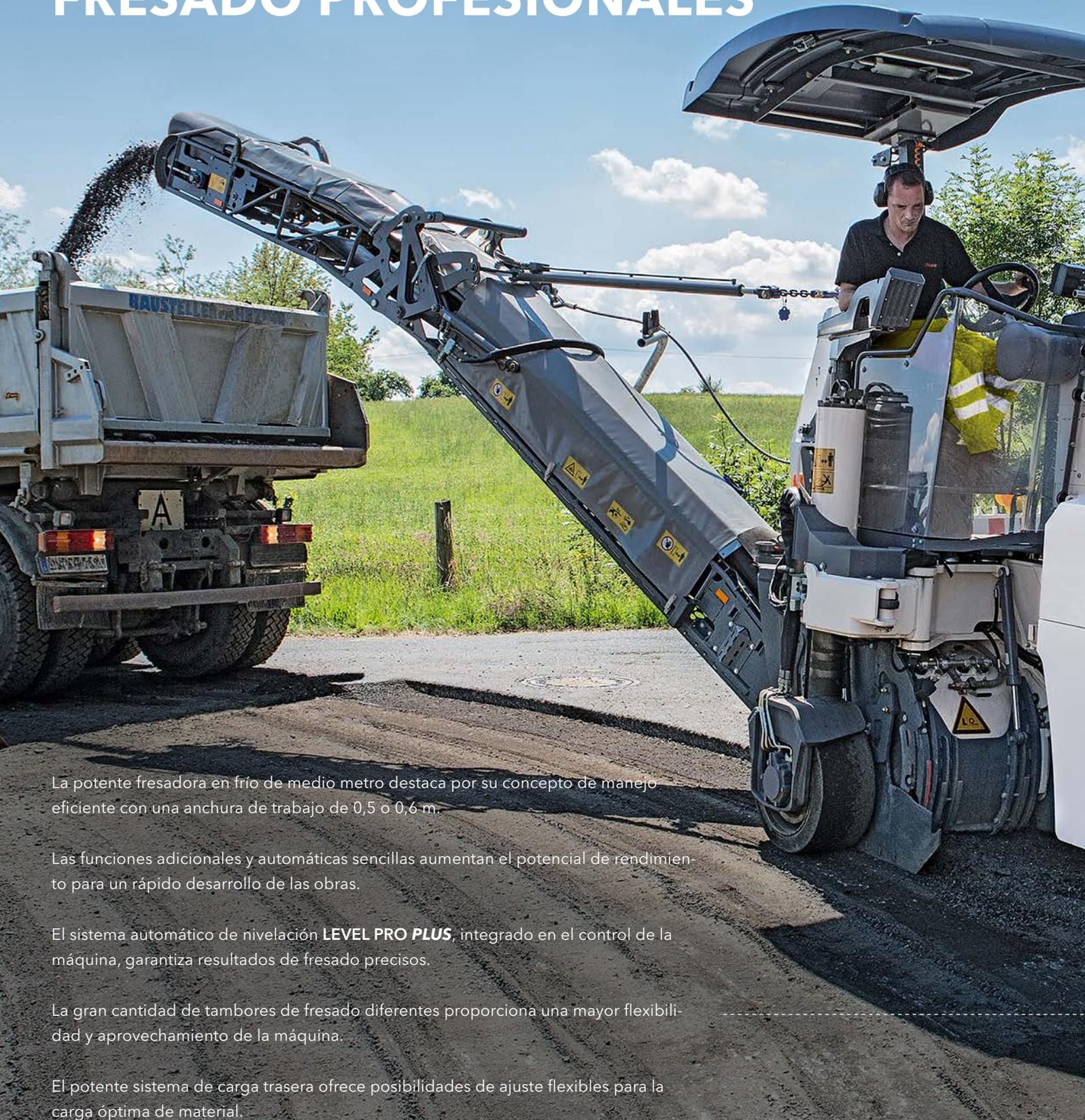
La potente fresadora en frío de medio metro destaca por su concepto de manejo eficiente con una anchura de trabajo de 0,5 o 0,6 m.
