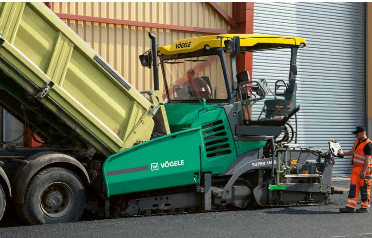
Der gefederte Abdruckbalken PaveDock kompensiert zuverlässig alle Stöße der Mischgutfahrzeuge.
