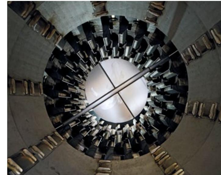
Zunächst werden die Abgase direkt am Ort ihrer Entstehung aktiv abgesaugt. Allen voran aus dem Mischer der Asphaltmischanlage - dort, wo das erhitzte Gestein, das Recycling-Material und das Bitumen aufeinandertreffen und zu frischem Asphalt vermischt werden. Die Dämpfe, die hohe Cges-Konzentrationen aufweisen, werden zur thermischen Nachbehandlung in das REVOC-System geleitet.
