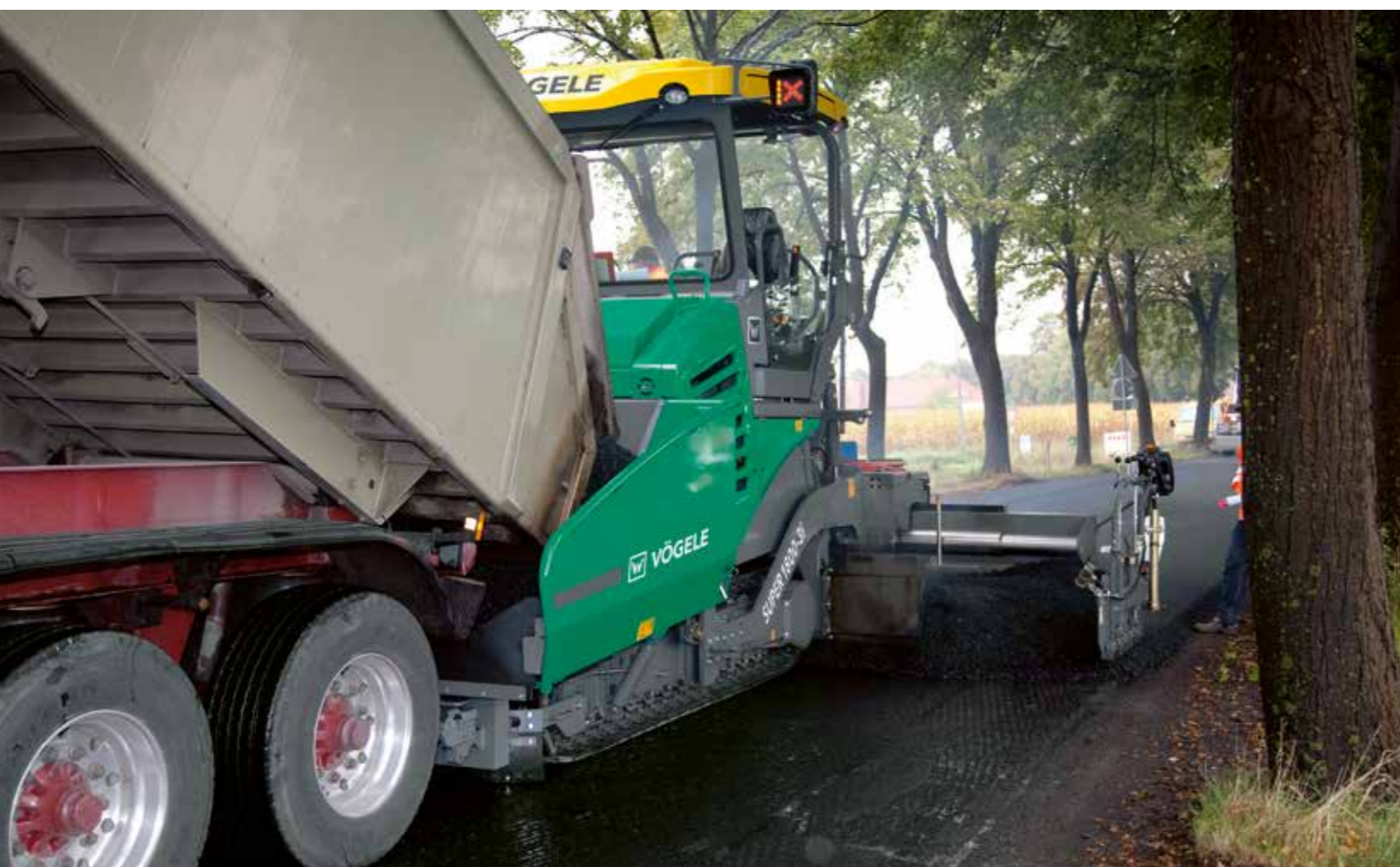
A barra de pressão com mola PaveDock absorve de forma confiável quaisquer solavancos dos veículos de alimentação.
