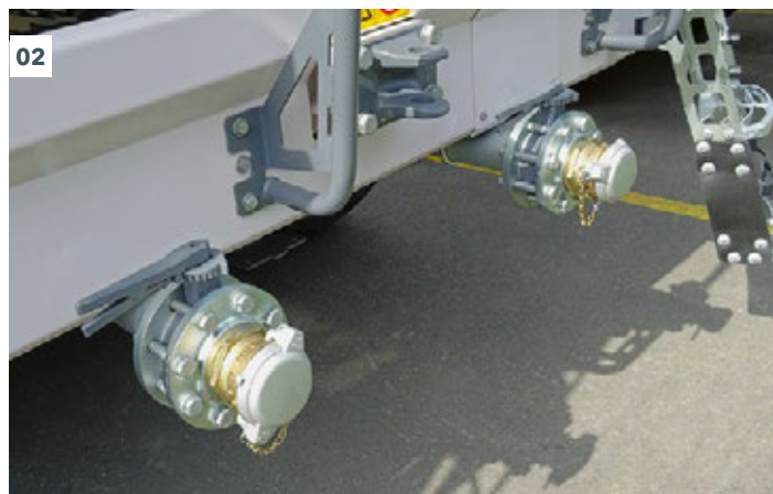
02 As conexões de água e emulsão são de fácil acesso.
