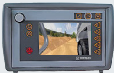
Câmera do lado esquerdo da máquina
