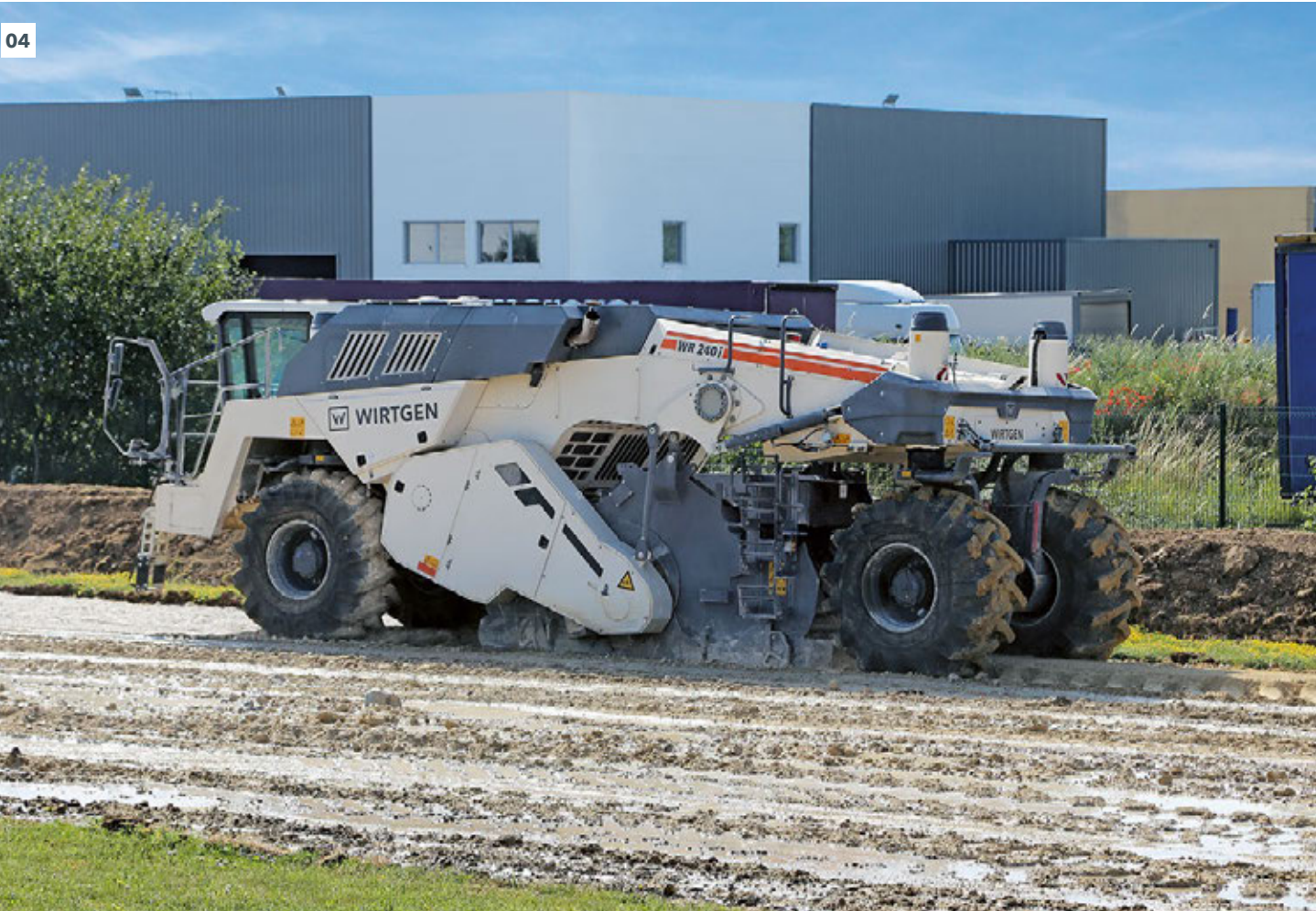
01 - 04 Os estabilizadores de solo transformam sub-bases com resistência deficiente em solos passíveis de pavimentação e compactação.
