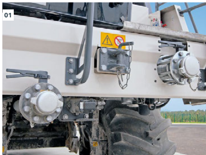
01 As barras de conexão para a espuma de asfalto são de fácil acesso.
