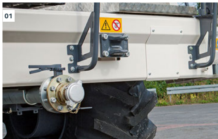
01 Todas as conexões de mangueira encontram-se na travessa dianteira.
