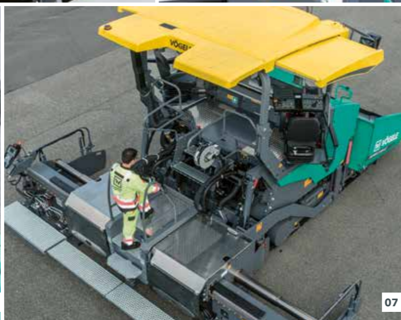
04 Пакет освещения «Плюс» для полезной подсветки рабочей зоны рабочего органа. 05 PaveDock Assistant упрощает коммуникацию между работниками при выгрузке смеси в бункер укладчика. 06 Эргономичное рабочее место с четким и понятным расположением рабочих органов. 07 Безопасная и удобная лестница на рабочем органе.
