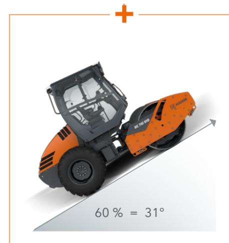
A combinação de design compacto, alta distância ao solo e grandes ângulos de inclinação permite uma condução segura mesmo em terrenos irregulares.
