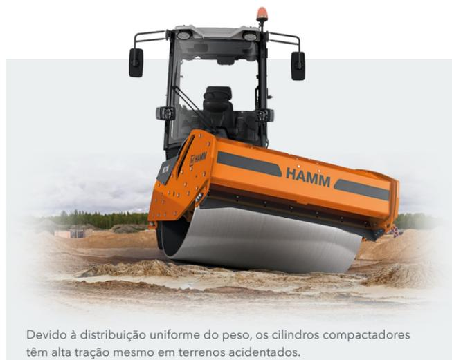
Devido à distribuição uniforme do peso, os cilindros compactadores têm alta tração mesmo em terrenos acidentados.
