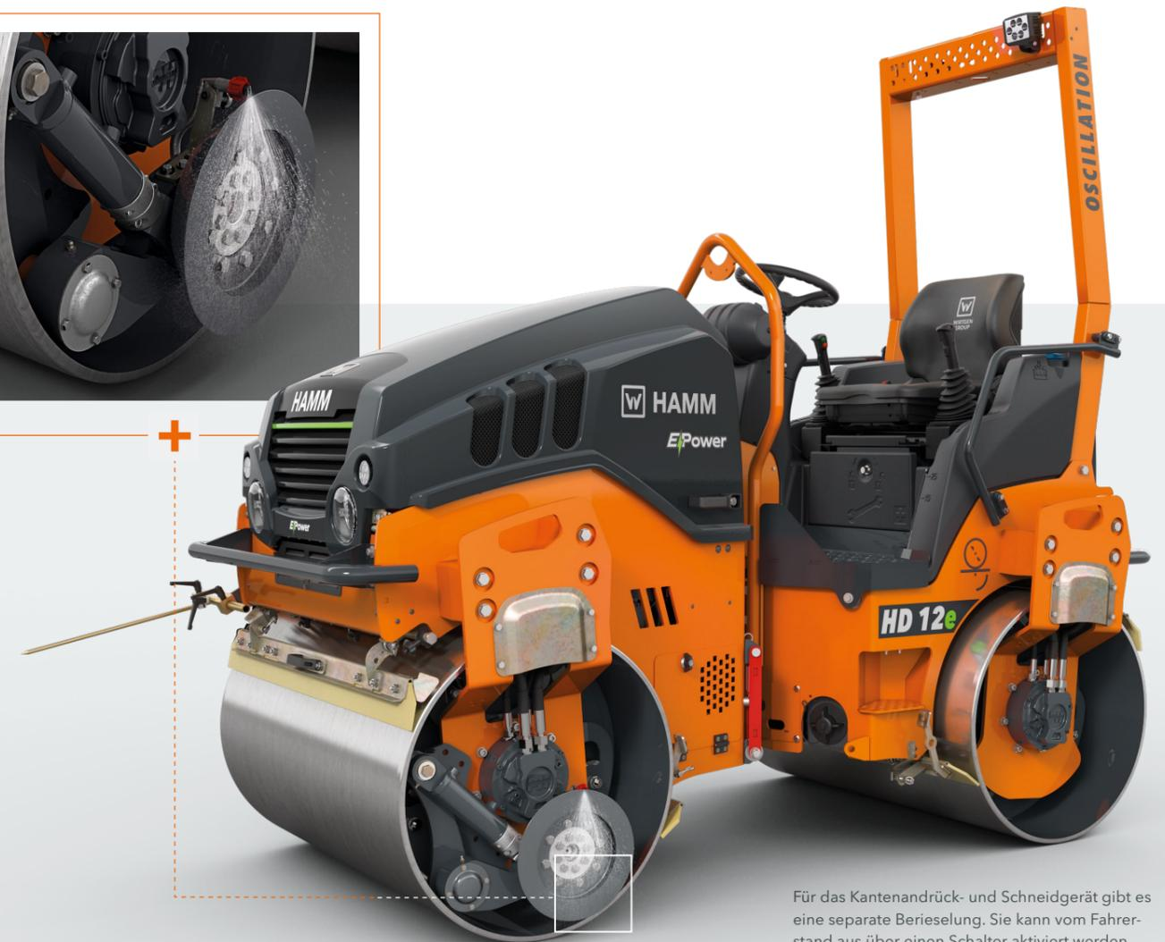
Für das Kantenandrück- und Schneidgerät gibt es eine separate Berieselung. Sie kann vom Fahrerstand aus über einen Schalter aktiviert werden. Der Wechsel von Druckrollen und Schneidrädern ist extrem einfach und schnell: Zentrale Schraube lösen - tauschen - fertig!
