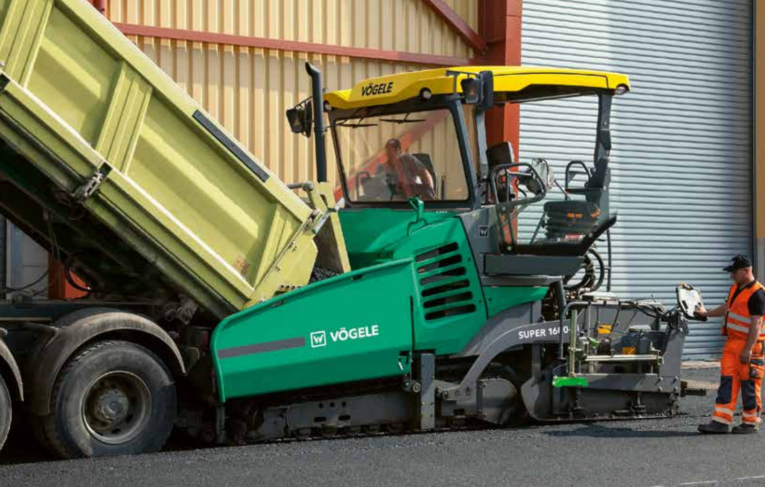
Yaylı itme makarası PaveDock, malzeme taşıtlarının tüm darbelerini güvenli biçimde dengeler.
