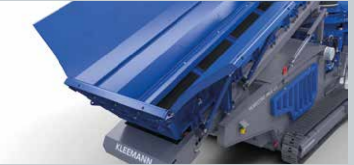
Mecanismo de inserção para adequação da parábola de descarga
